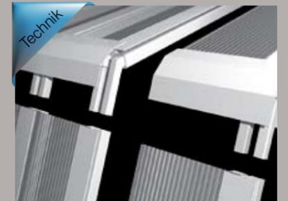
Bei den Modellen PROFESSIONAL und PRACTIC werden an den Schnittpunkten des Dachpanels und der geraden Seitenwand Eckverstärkungen mit hoher Tragfähigkeit eingesetzt. Diese werden aus lasergeschnittenem Chromstahl hergestellt.
