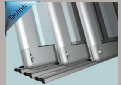
Die innenliegende, automatische Arretierung ist eine unter Gebrauchsmusterschutz stehende Erfindung von AQUACOMET. Die innenliegenden Arretierungen positionieren und fixieren die Segmente beim Schließen automatisch an der dafür vorgesehenen Stelle um eine optimale Abdichtung zu erreichen. Die Arretierkonstruktion befindet sich in der Kunststoff-Verschlusskappe, welches das Aluminiumprofil abschließt.
