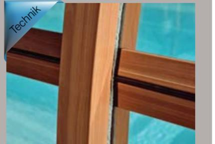
Die nach oben verschiebbaren Seitenwände des Modells GALAXY werden mit 3 mm starken, flexiblen, massiven Polycarbonatplatten angefertigt. Jede Seitenwand hat eine eingebaute Sturzsicherung, die bei unbeabsichtigtem Loslassen sofort greift und somit den Sturz vermeidet. Die Laufbahnen der Seitenwände sind mit Bürsten verdeckt, um eine leichtere Bewegung und eine Abdichtung zu sichern.
