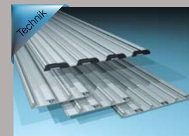
Nahezu alle Überdachungsmodelle von AQUACOMET werden bis zu einer Spannweite von ca. 6m mit einer extraflachen Schienenbahn geliefert. Die Schienenbahn ist modulweise, fugenlos erweiterbar für die Aufnahme von 2-3-4-5-6 verschiebbaren Segmenten. Die Höhe der Laufschiene ist 12 mm, diese ist auch barfuß bequem begehrbar. Die Konstruktion der Schiene bietet eine permanente Wind- und Sturmsicherung.
